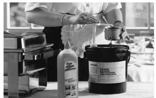
Fig. 3: ricaricare in modo sicuro il bruciatore a pasta.
