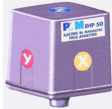
Il PMM EHP-50A è un Sensore isotropico-analizzatore di campi elettrici e magnetici a bassa frequenza, che fornisce una soluzione ad alta tecnologia, per la misura di campi da pochi V/m o nT a migliaia di V/m o mT nell'intervallo da 5 Hz a 100 kHz, sugli assi X, Y e Z.
