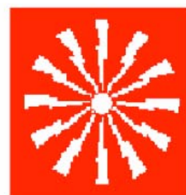
PULSANTE DI ALLARME ANTINCENDIO
