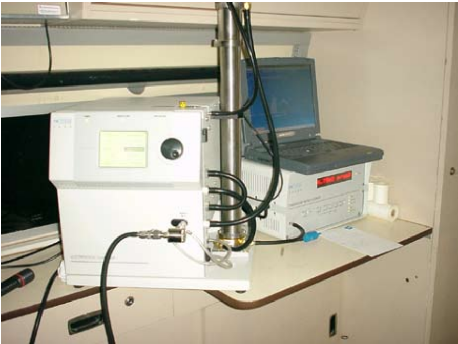
Abbildung 5: SMPSTM ™ -Gerät (Scanning Mobility Particle Sizer) der Firma TSI.
