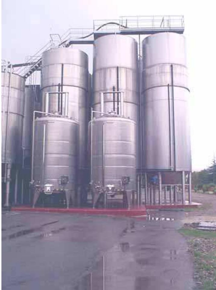
**Fig. n. 21** Veduta esterna dei *fermentini* in acciaio inox. I due vasi più bassi in primo piano sono dotati organi a pistone per la follatura del mosto (si notino i pistoni che fuoriescono dalla parte alta dei vasi).
