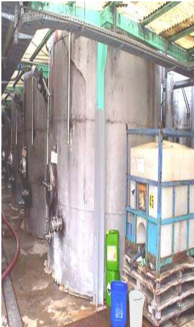
**Fig. n. 43 Contenitore dell'ipoclorito di sodio in uso in una azienda per la pulizia dei vasi vinari.**
