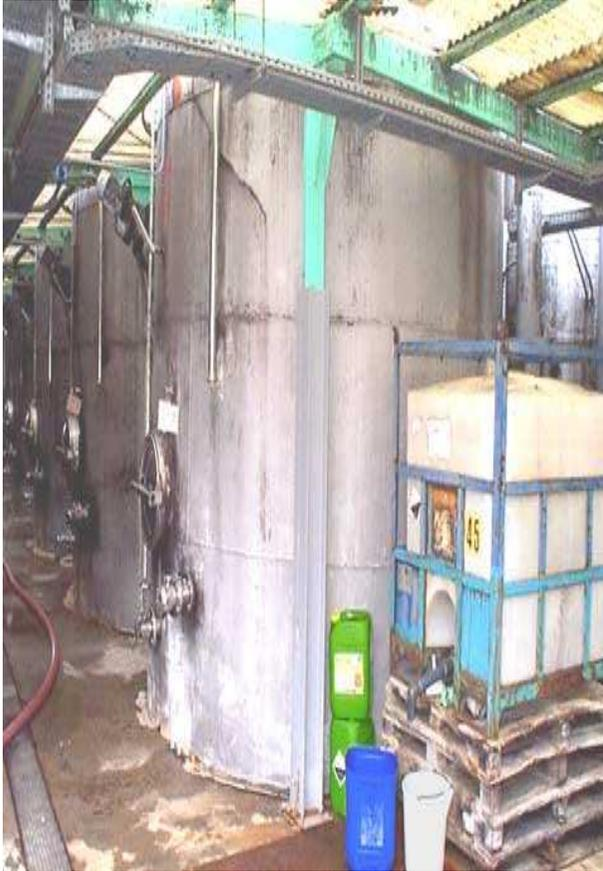
**Fig. n. 12 Fila di fermentini dotati di agitatori (si notino i motori che fuoriescono dall'alto del loro lato sinistro).**
