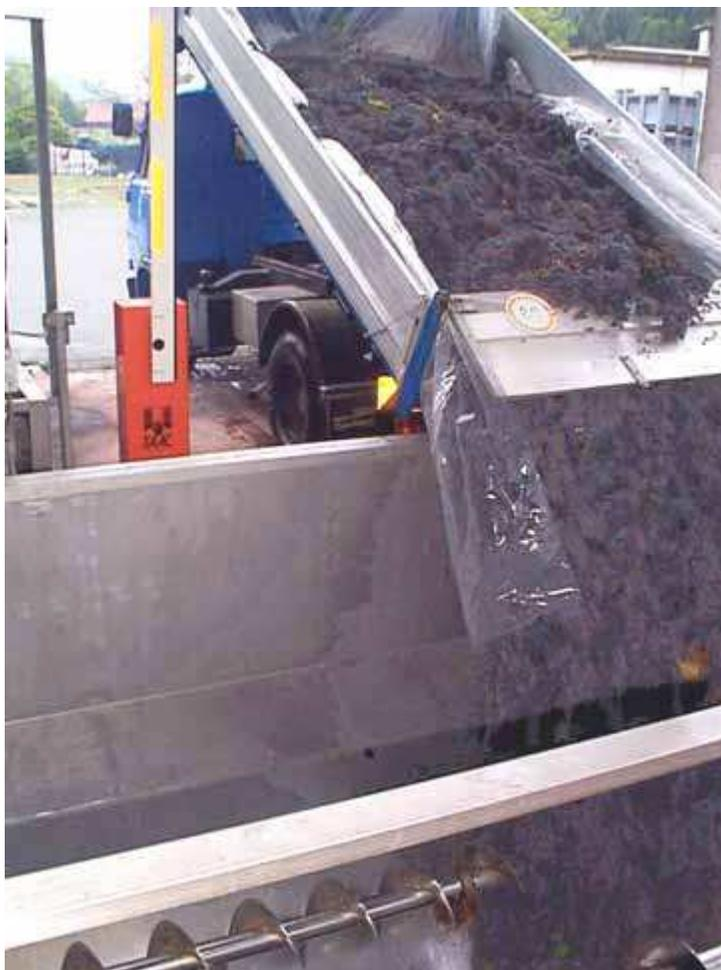
**Fig. 7 Scarico nella *tramoggia con coclea* dell'uva nera da un camion con cassone ribaltabile. Si noti il telo di plastica sul fondo del cassone, l'organo lavoratore (coclea) sul fondo della tramoggia, la sbarra con funzione di parapetto mobile contro la caduta dall'alto di persone nella *tramoggia*.**
