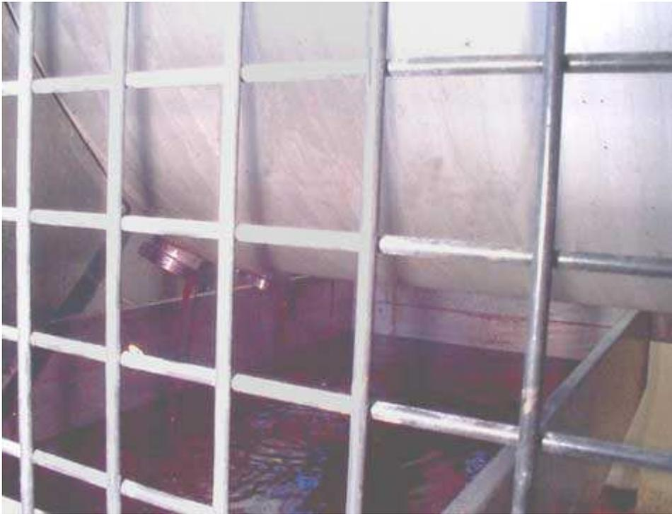
**Fig. n. 28** Pressa per vinacce (simile alla precedente). Si noti le griglia di protezione della parte rotante.
