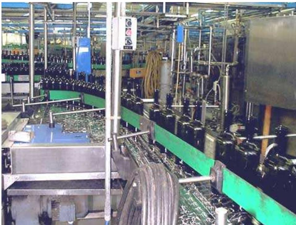
**Fig. n. 48** Trasporto delle bottiglie vuote su nastri a velocità variabile che determinano il distanziamento tra le bottiglie prima di essere avviate al lavaggio.
