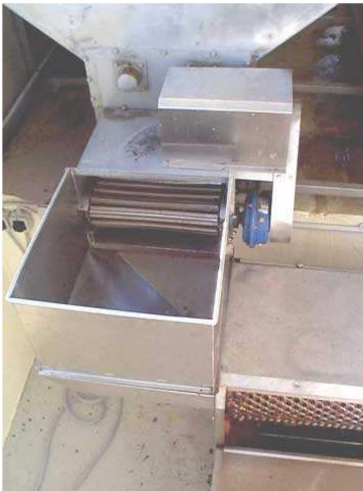
**Fig. 4** Particolare degli organi lavoratori della *diraspatrice* con ripari rimossi per pulizia (vista dall'alto). Si noti a sinistra il nastro trasportatore che proviene dal fondo della *tramoggia* e a destra il cilindro forellato di acciaio della *diraspatrice*.
