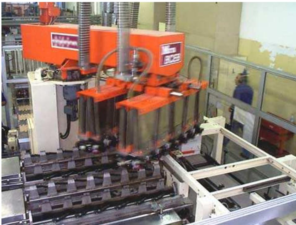
**Fig. n. 55 Robot per l'inscatolamento orizzontale delle bottiglie pronte. Tutta la macchina è recintata da protezioni trasparenti fisse o munite di dispositivo di interblocco (vedere la figura seguente).**
