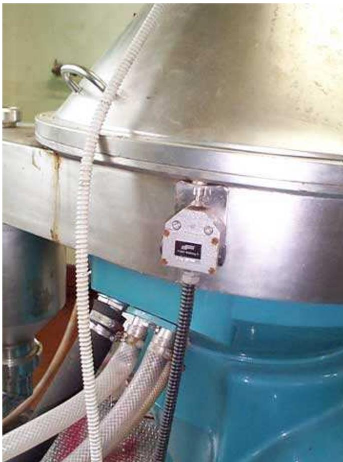
**Fig. n. 40 Particolare del dispositivo di interblocco sul coperchio della centrifuga per la pulizia del vino.**
