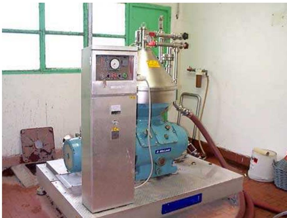
**Fig. n. 35 Centrifuga per la pulizia del vino.**
