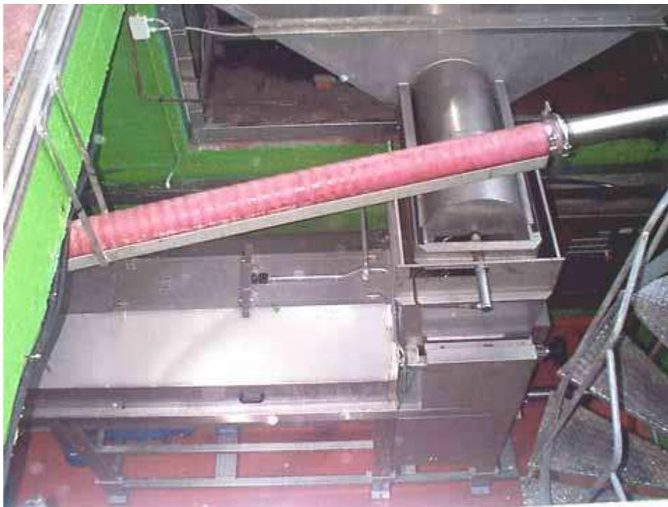
**Fig. 3** *Diraspatrice ad asse orizzontale (vista dall'alto) posta al di sotto della tramoggia (di quest'ultima si nota la parte terminale dove l'uva viene spinta nella diraspatrice); sulla destra è presente la scala a chiocciola per l'accesso al piano dove si trova la diraspatrice.*
