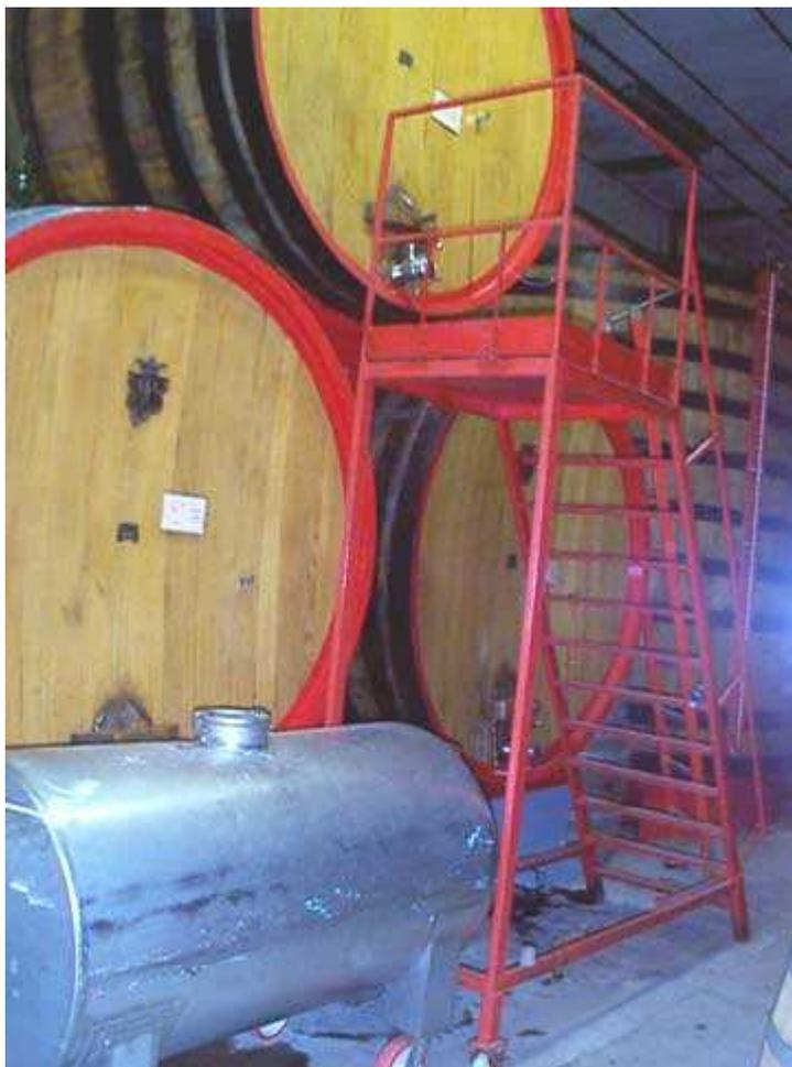
**Fig. n. 33** Scala portatile su ruote con ballatoio dotato di parapetto. La scala è incatenata tramite un gancio alla struttura sulla quale è posta la botte superiore, allo scopo di impedire il rischio di ribaltamento della scala.
