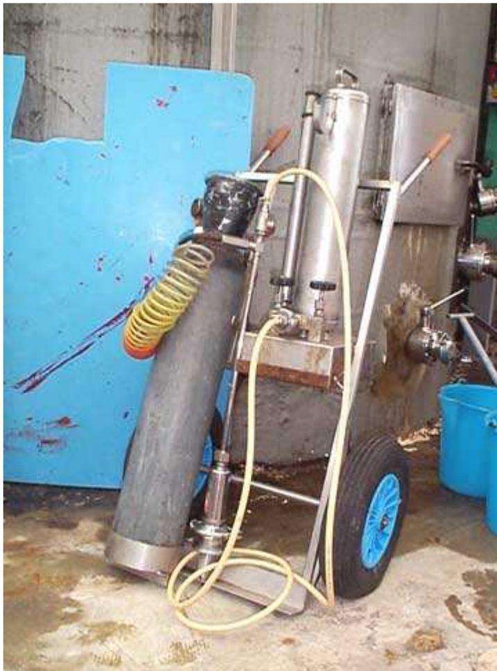
**Fig. n. 17 Carrellino per il trasporto di una bombola di azoto e una di anidride solforosa.**
