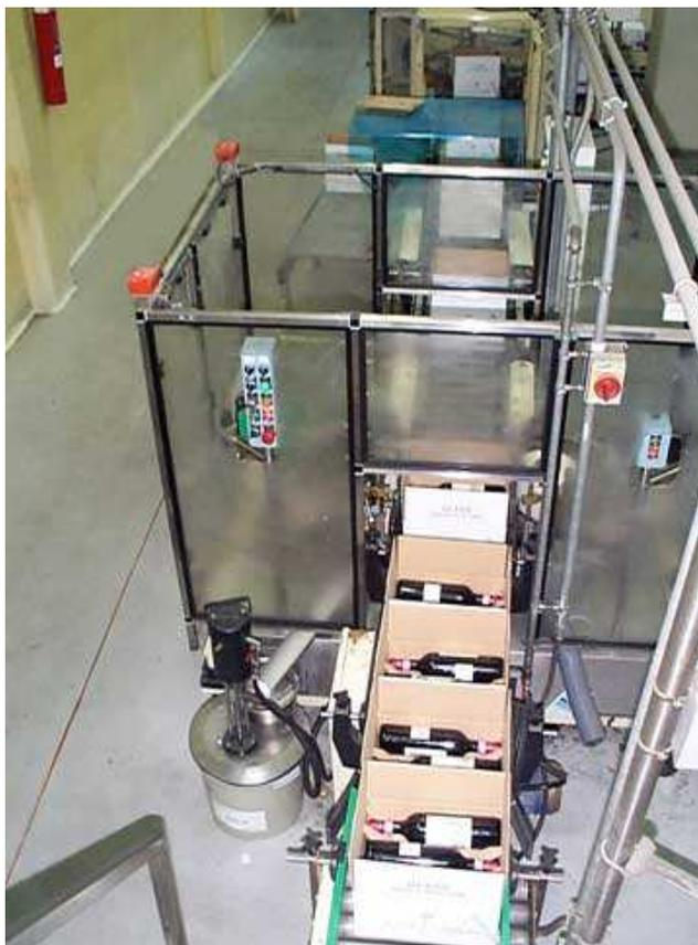
**Fig. n. 56** Ingresso delle scatole piene di bottiglie verso la linea di chiusura delle scatole e pallettizzazione.
