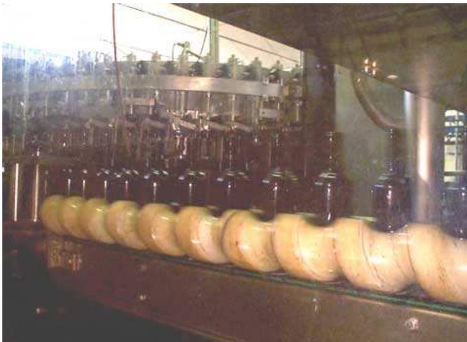
**Fig. n. 51** Uscita delle bottiglie dalla macchina di riempimento. Le bottiglie piene di vino sono distanziate tra loro grazie ad una vite senza fine. Tutta la macchina è protetta da schermi di plastica trasparente, fissi o muniti di dispositivi di interblocco.
