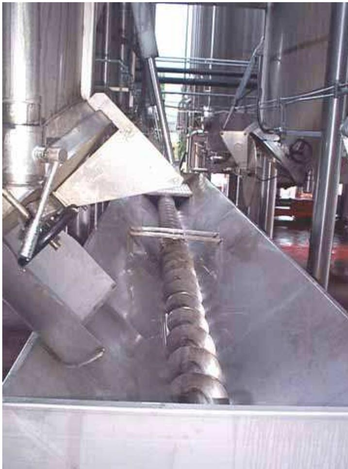
**Fig. n. 26** Tramoggia con coclea fissa e posta tra due file di *fermentini* all'aperto, utilizzata per il trasporto alla pressa della parte solida del mosto rimasta dalla *svinatura* (protezione della coclea rimossa per manutenzione).
