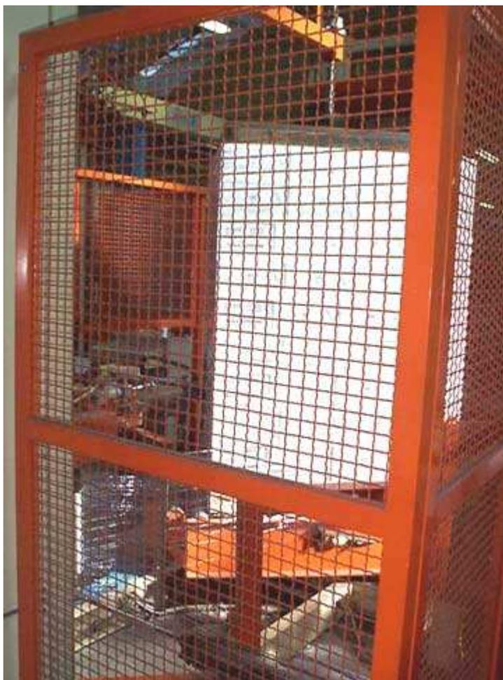
**Fig. n. 60** Macchina imballatrice con nastro di plastica di un *palletts* di scatole piene di bottiglie.
