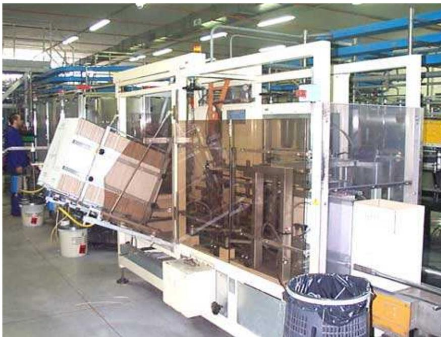
**Fig. n. 54 Alimentazione delle scatole di cartone piegate e uscita delle scatole aperte nelle quali sono poi inserite le bottiglie pronte.**
