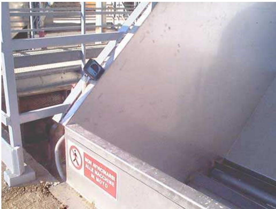
**Fig. 8 Particolare della *gramola* (in fase di carico) dotata di fotocellula che blocca in movimento della coclea in caso un lavoratore si avvicini alla macchina in moto.**
