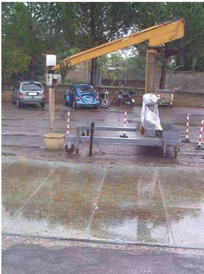
**Fig. 1 Zona di pesata dei mezzi con pesa a ponte (bascula) e coclea mobile per il prelievo del campione d'uva.**
