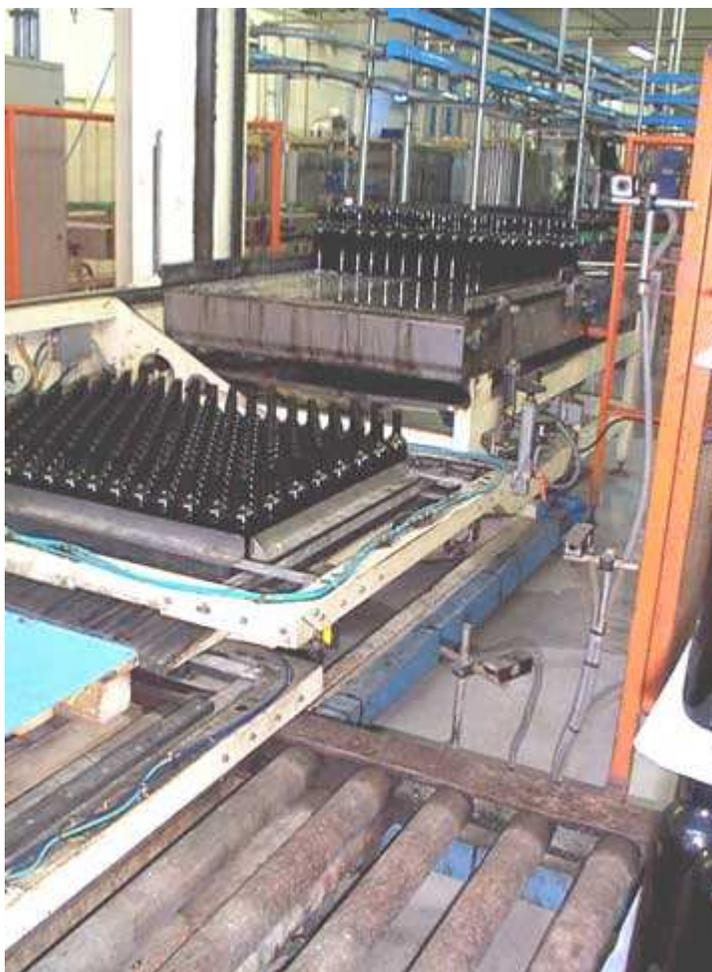
**Fig. n. 47** Caricamento tramite robot di uno strato di bottiglie prelevate dalla pila. Si noti la rulliera (in primo piano nella figura), lo strato di bottiglie cinto dal robot (in secondo piano nella figura) e le bottiglie poste sui nastri trasportatori della linea di imbottigliamento del vino (sullo sfondo). Si notino le fotocellule e le recinzioni di protezione a lato della macchina.
