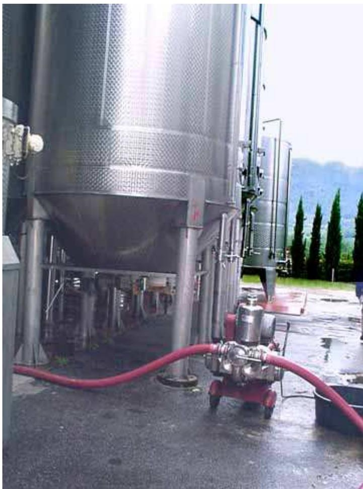
**Fig. n. 9** Pompa di travaso di medie dimensioni.
