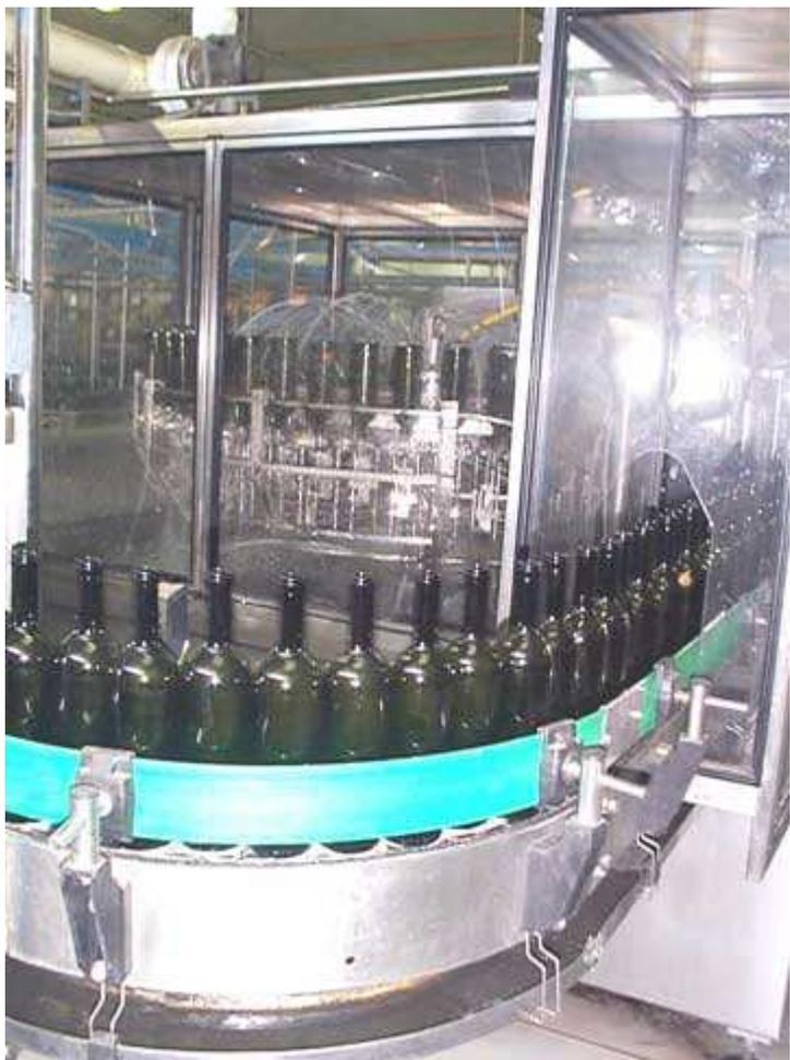
**Fig. n. 49** Ingresso delle bottiglie vuote nella macchina di lavaggio.
