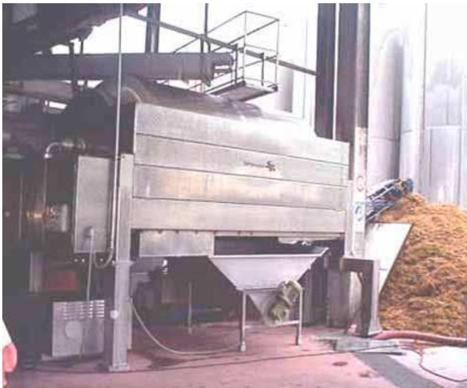
**Fig. n. 27 Pressa per vinacce. Si notino le vinacce ammucchiate all'uscita della macchina e la tramoggia posta sotto la pressa per la raccolta del liquido.**
