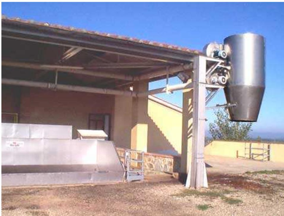
**Fig. 5** Sistema pneumatico di estrazione dei raspi dalla *diraspatrice* (in alto a destra si noti il ciclone di uscita e sotto il tetto la tubazione di trasporto).
