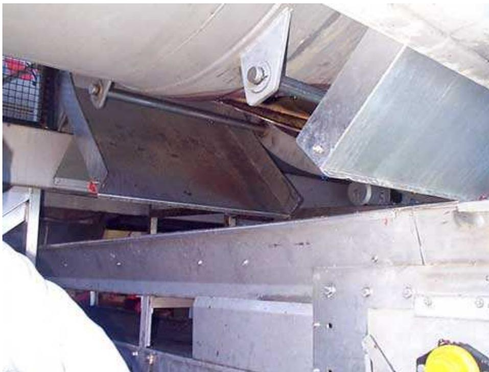
**Fig. n. 30** Parte inferiore della pressa per vinacce in posizione di scarico con riparo dotato di dispositivo di interblocco rimosso per il lavaggio.
