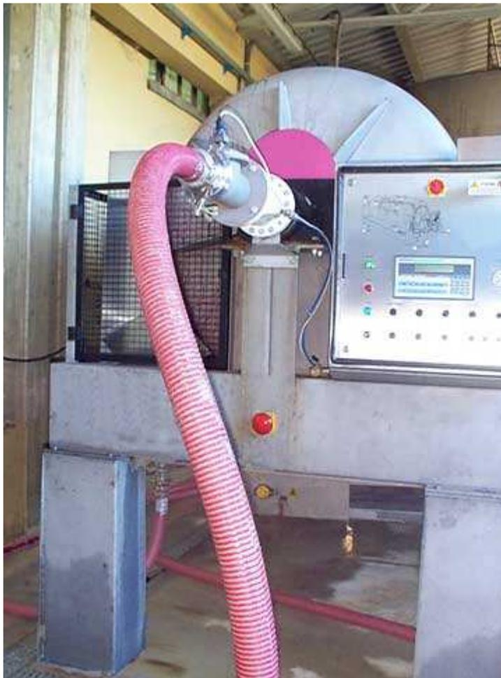
**Fig. n. 29 Raccolta del liquido dalla parte inferiore della pressa per vinacce.**
