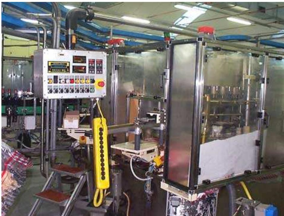
**Fig. n. 53** Macchina etichettatrice. Si noti la pulsantiera per il funzionamento ad impulsi "a uomo presente" per le regolazioni iniziali e il ripristino in caso di inceppamento della macchina.
