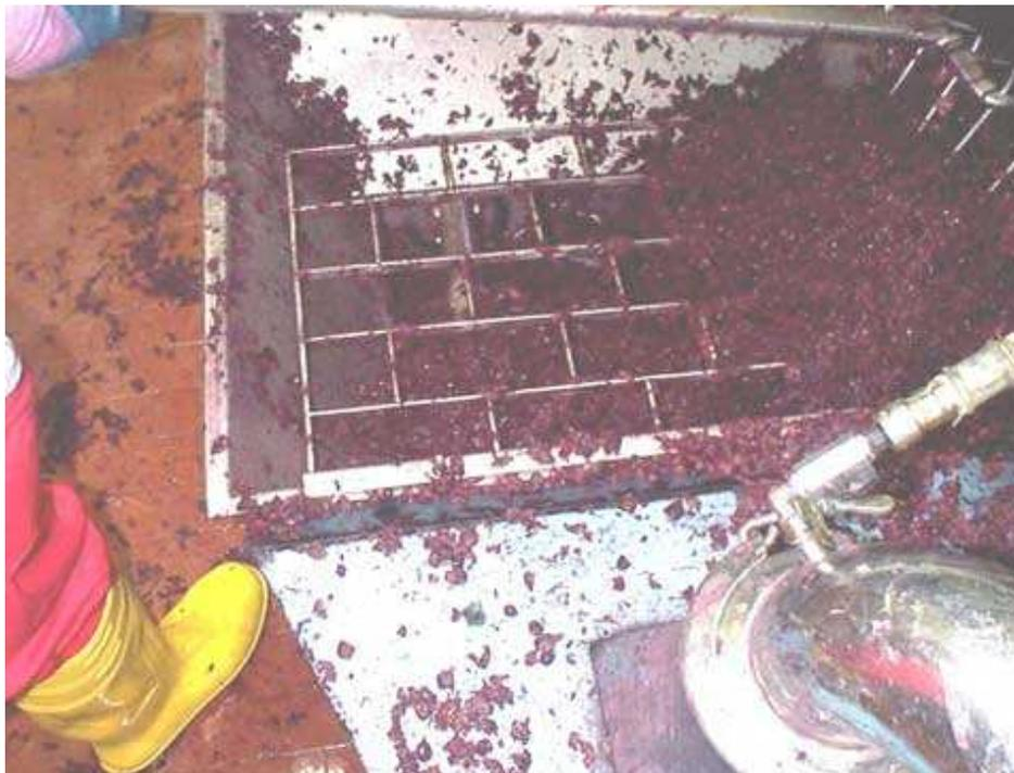
**Fig. n. 24 Particolare della figura precedente. Si noti la griglia di protezione degli organi lavoratori.**
