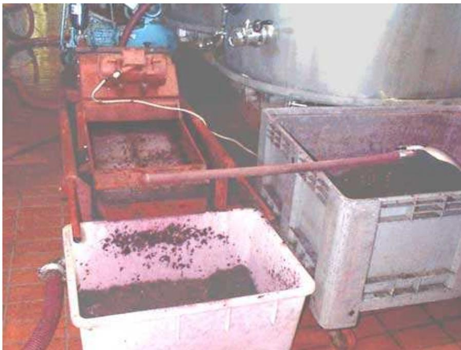
**Fig. n. 22 Filtratura grossolana della parte liquida del mosto appena svinato mediante filtro a vibrazione. Le vibrazioni fanno avanzare le vinacce sulla superficie del filtro fino a farle cadere in un contenitore di raccolta, da cui sono poi prelevate con il badile e immesse nella *menestrina* che alimenta la pressa per vinacce.**
