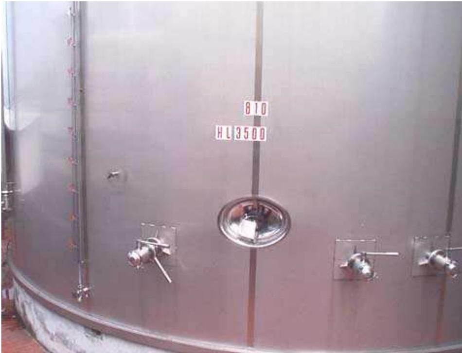
**Fig. n. 16** Base di un vaso vinario in acciaio inox da 3.500 ettolitri. Si noti il *passo d'uomo*, le tre *spine* e la scala graduata per la misurazione della quantità di vino presente nel contenitore.
