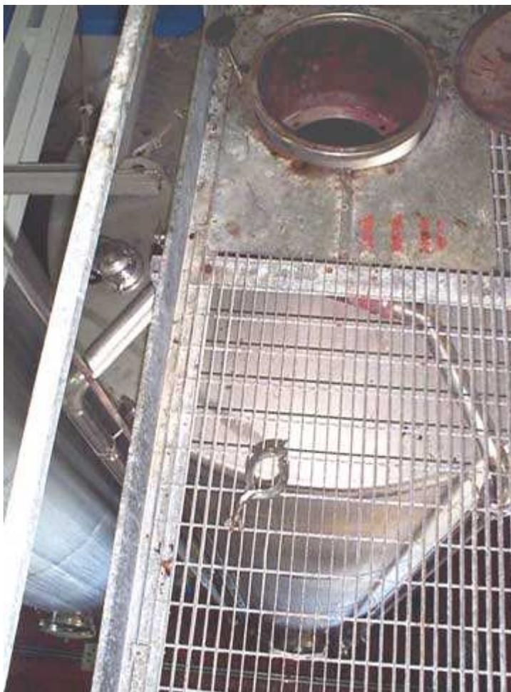
**Fig. n. 19 Tino in acciaio visto dall'alto si noti il pavimento grigliato della passerella e il portello superiore aperto.**
