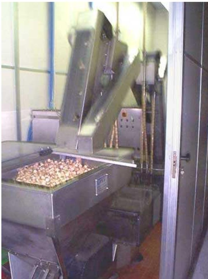
**Fig. n. 52** Macchina di alimentazione dei tappi di sughero per tappare le bottiglie piene di vino. La macchina è segregata in un apposito locale insonorizzato.
