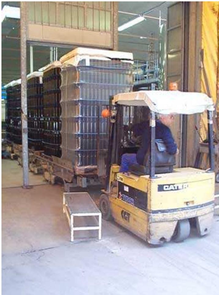
**Fig. n. 45 Carrello elevatore che trasporta le pile di bottiglie e le carica sull'alimentatore a rulliera della linea di imbottigliamento del vino.**
