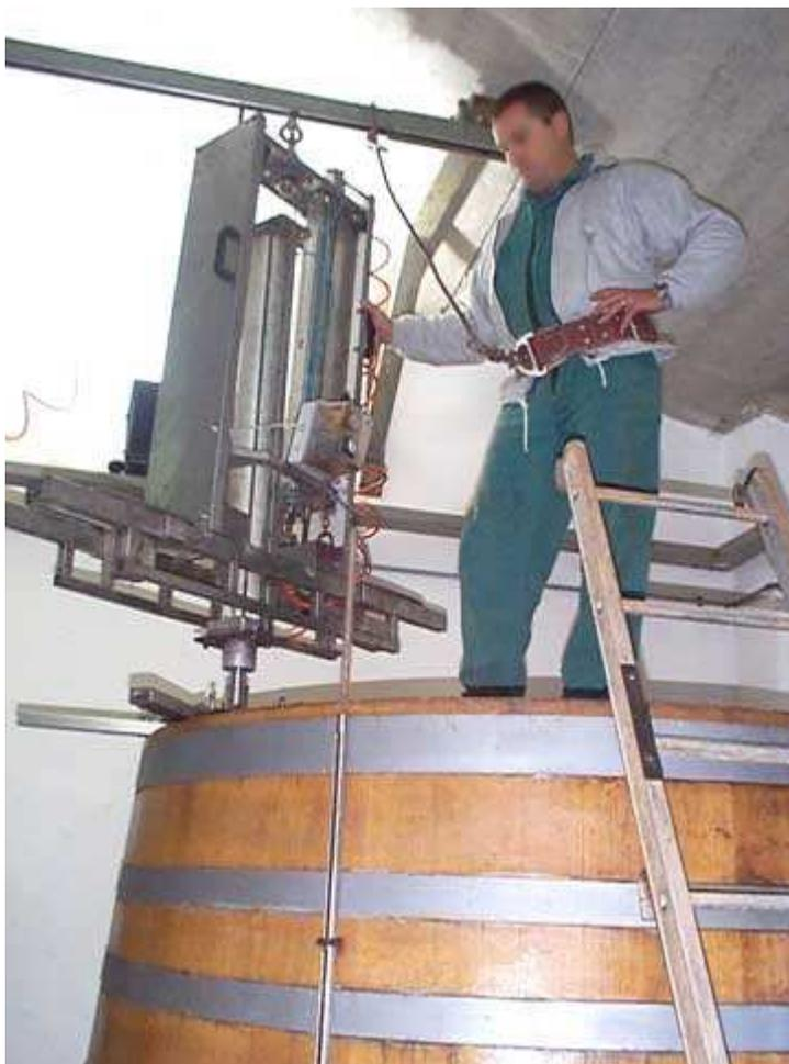
**Fig. n. 18 Attrezzo di follatura su monorotaia aerea con organo follatore a croce a movimento pneumatico. La monorotaia fissata al soffitto corre sopra i tini in legno. Si noti che l'addetto indossa la cintura di sicurezza fissata alla monorotaia. La scala è dotata di appositi rampini per essere fissata al bordo superiore del tino e di basi di appoggio al pavimento con rinforzi in gomma antiscivolo.**
