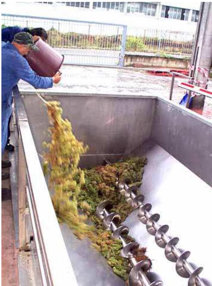
**Fig. 2 - Scarico manuale di una cesta di uva bianca nella *gramola*.**
