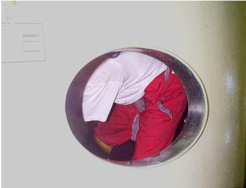
**Fig. n. 25 Un addetto alla estrazione delle vinacce che è entrato dentro il tino per completare l'operazione.**
