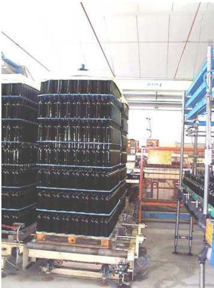
**Fig. n. 46** Pile di bottiglie sull'alimentatore della linea di imbottigliamento del vino. Si noti la rulliera sulla quale avanzano le pile, il pancale di legno alla base della pila, il cappuccio di cartone in cima alla pila e i fogli di cartoncino tra i vari strati della pila.
