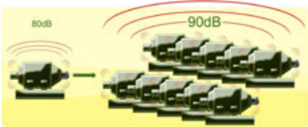
Figura 1.11.b Somma dei livelli di pressione acustica
