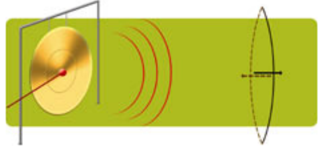
Figura 1.1 Il gong e la sua vibrazione superficiale
