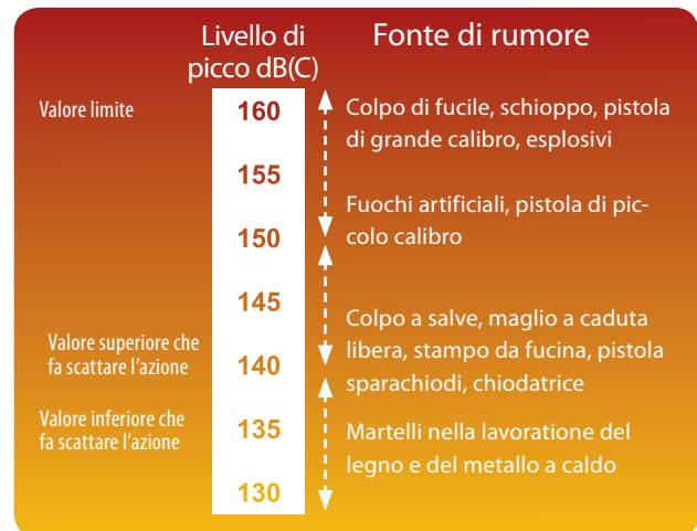
Figura 2.3 Livelli di pressione acustica di picco tipici delle fonti impulsive
