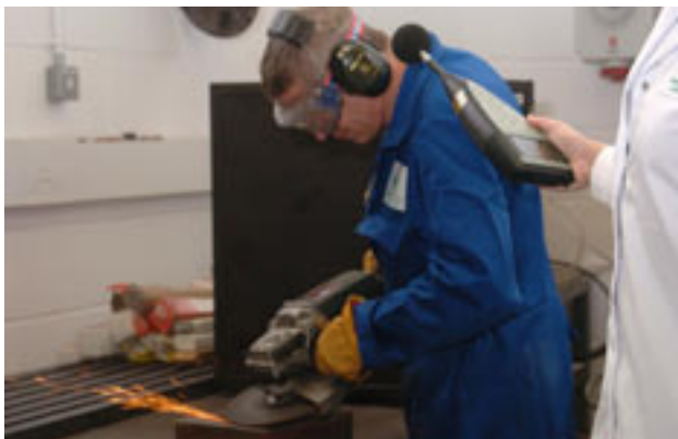
Figura 2.11 Misurazione del livello acustico vicino all'orecchio di un lavoratore Foto © e gentile concessione dell'Health and Safety Executive – Gran Bretagna.
