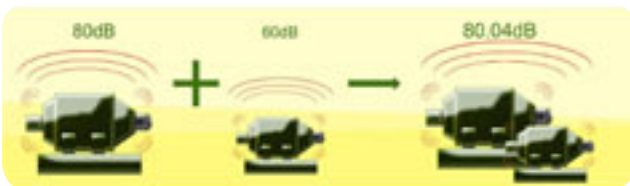
Figura 1.11.c Somma dei livelli di pressione acustica
