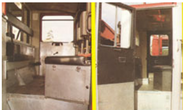
Figura 4.16 Trasporto – Nella cabina di questo veicolo per il trasporto su strada del personale il rumore è ridotto rivestendo il pavimento e le pareti laterali con fibra di vetro ricoperta di lamiera d'acciaio e rivestendo le altre superfici con materiale assorbente. © Gentile concessione dell'Health & Safety Executive – U.K.
