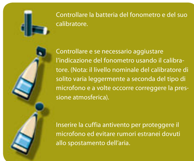
Figura 2.10 Preparazione della misurazione: le istruzioni del produttore
