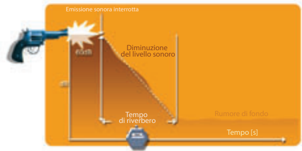
Figura 3.4 Le influenze acustiche dell'ambiente possono essere valutate interrompendo un suono e misurandone il decadimento dovuto alla riflessione superficiale. Il "tempo di riverbero" ( T_r ) è il tempo impiegato per un decremento di 60 dB del livello sonoro.
