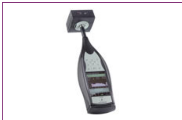
Figura 2.5 Fonometro con calibratore acustico Foto © e gentile concessione di Bruel & Kjaer
