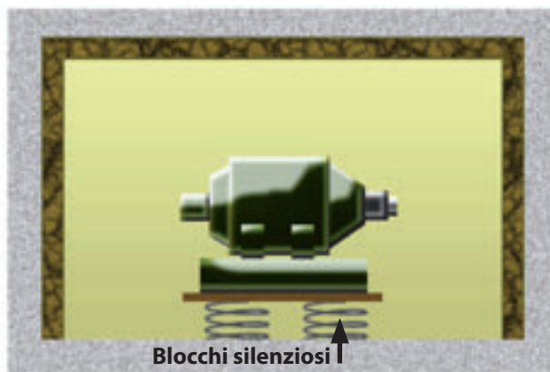
Figura 4.14 Occorre separare le attrezzature rumorose.
