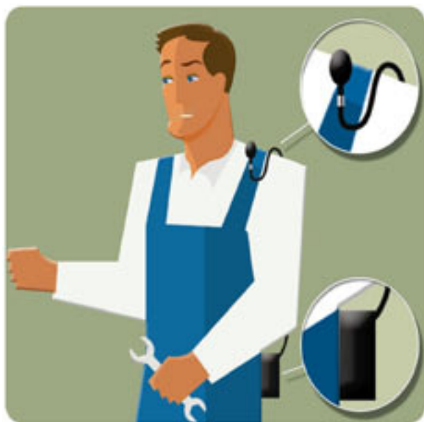
Figura 2.12 Microfono del dosimetro posizionato sulla spalla
