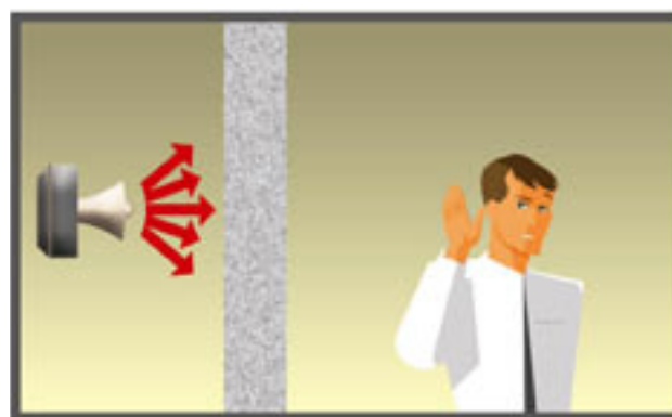
Figura 4.12 Separare le attrezzature rumorose mediante pareti
