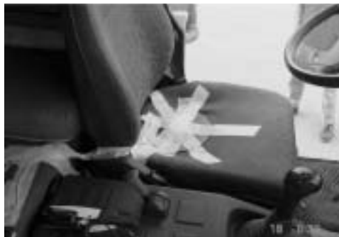
Figura 5: Modalità di installazione della strumentazione sul sedile di guida
